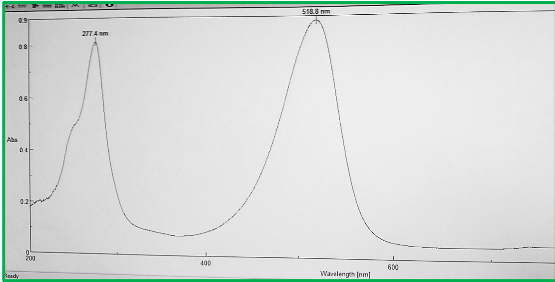
شكل (4-3) طيف امتصاص الاشعة (UV-VIS) لصبغة السفراين عند pH=9
